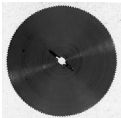
Photo 3. La roue à denture fine, agrandie sur la photo 3a, a été positionnée sur le carré de l'arbre de barillet. Les cliquets de retenus sont en prise avec sa denture.
