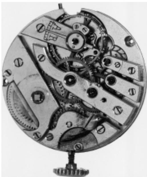
Photo 1. Le mouvement seul, calibre 9 lignes (20,3 mm).
