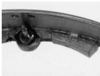
Photo 2a. Agrandissement d'une partie de la carrure de la boîte, permettant de voir le tigeon servant au pivotement de la masse.
